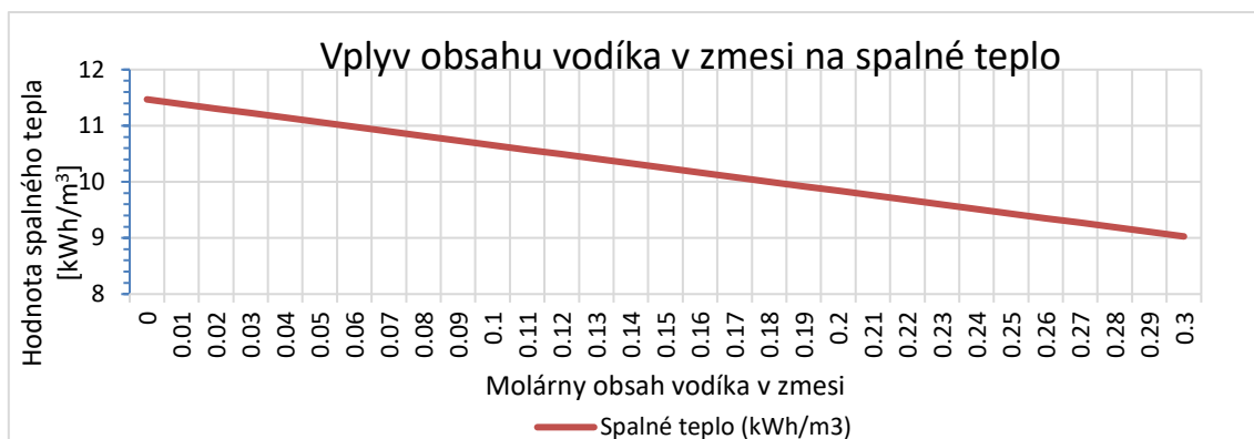
Obrázok 7 Vplyv obsahu vodíka v zmesi na spálne teplo podľa modelu GERG-2008
