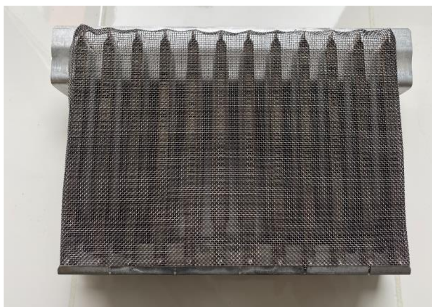
Obrázok 12 Upravený horák pomocou sita s rozmerom oka 1,5 x 1,5 mm.
