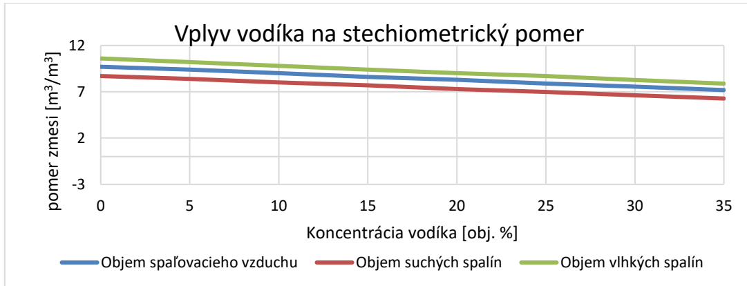
Obrázok 3 Vplyv vodíka na stechiometrický pomer
