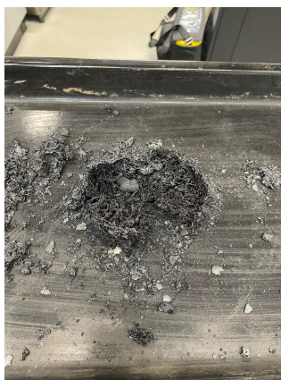
Obrázok 3 Tuhý zvyšok po pyrolýze plastových karosárskych dielov
