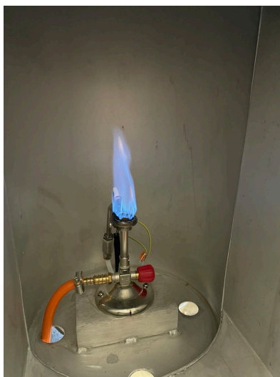
Obrázok 3 Horenie pyrolýzneho plynu v dopaľovacej komore
